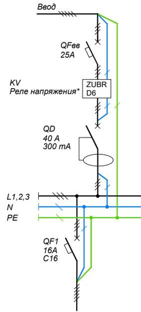
*\*Для корректной работы ZUBR D6 достаточно подключения нуля на одну из нулевых клемм (4 или 8)*
